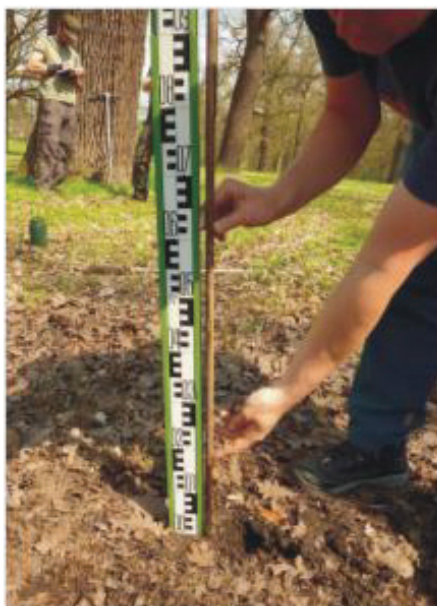
Obr. 2. Měření hladiny podzemní vody pomocí geodetické latě ve vrtu provedeném půdním vrtákem
