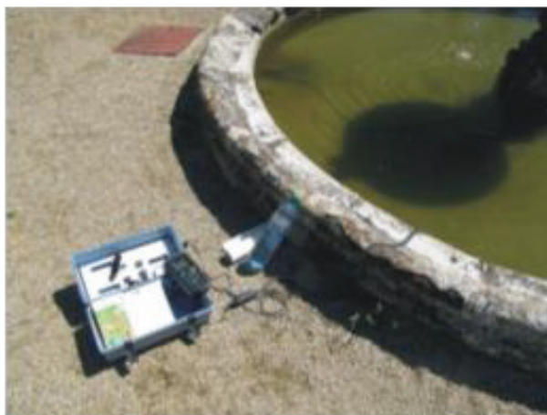
Obr. 3. Příklad měření fyzikálně-chemických veličin vody v terénu pomocí přenosného přístroje
